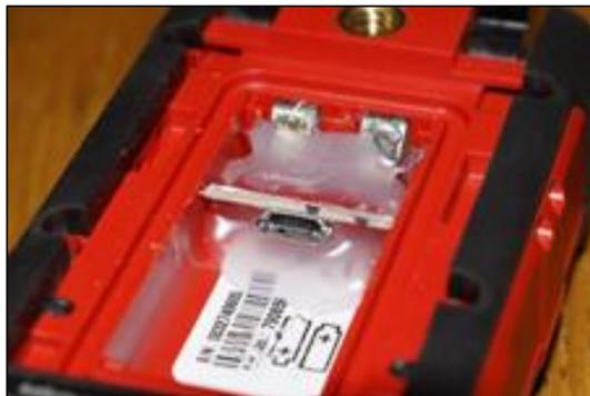
16) Enlever les contacts de piles inutilisés de l'autre côté du compartiment des piles.
