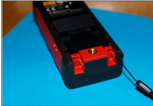
Les deux axes de support sont collés au boîtier côté intérieur au-dessous de la carte mère. Il faut pousser les deux axes vers l'extérieur mais on risque alors d'enlever la colle qui fait étanchéité. Si la colle est endommagée pendant le démontage, il faudra la remplacer pour restaurer l'étanchéité de l'appareil (utiliser de l'Araldite ?)
