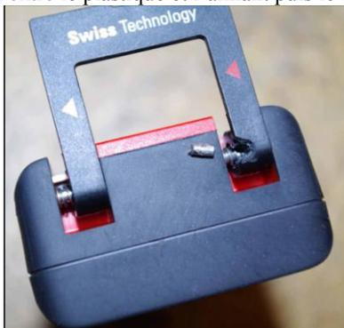
8) Monter la carte X2 de remplacement, replacer la vis d'origine et ressoudez les contacts vers le
