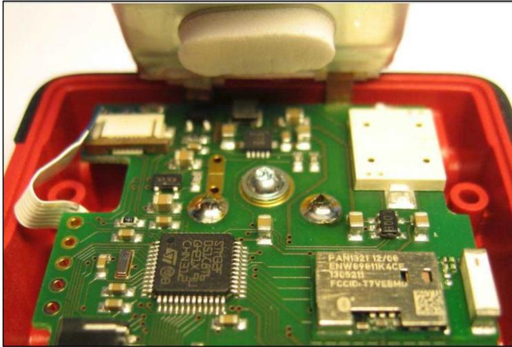
9) Brancher les câbles en nappe du capteur et du module laser.
