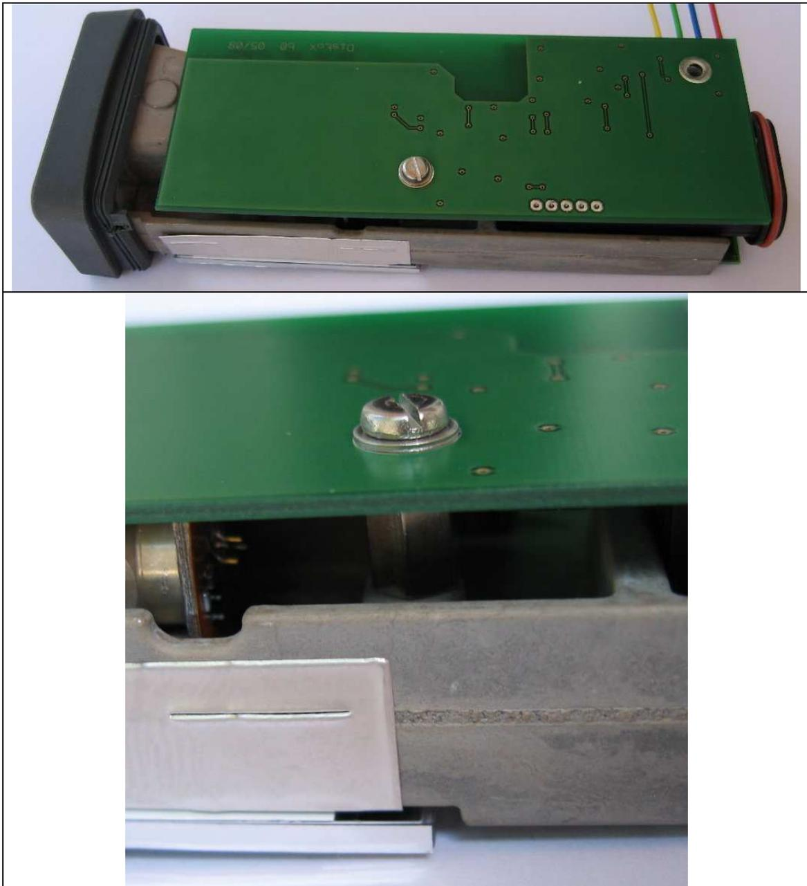
13) Suelde el final de los 4 cables en sus contactos de la placa base (Fig. 8 & 9).
